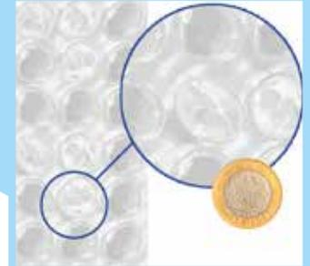
El polipack es un material producto de la polimerización del etileno, formado por millones de celdas cerradas e incomunicadas que contienen aire en su interior. Su estructura lo hace ideal como material de empaque y embalaje de productos, brindando la máxima protección.
